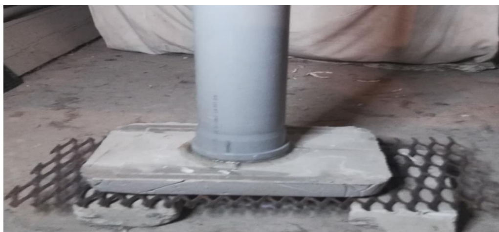
Рисунок 4.7 – Подготовленная установка для проведения эксперимента водонепроницаемости бетонной плиты
