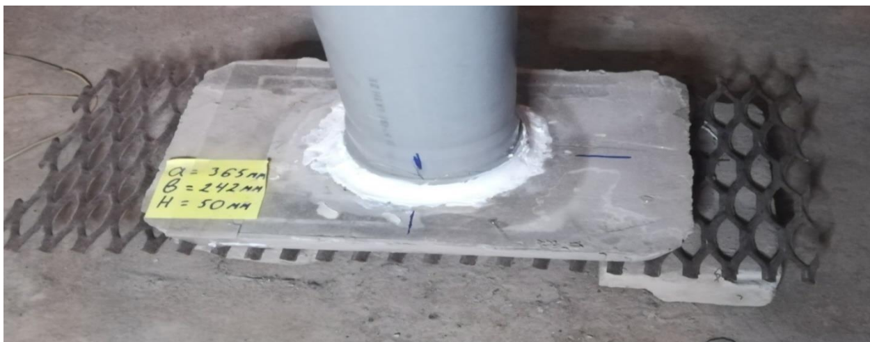
Рисунок 4.10 – Поглощение бетоном влаги
