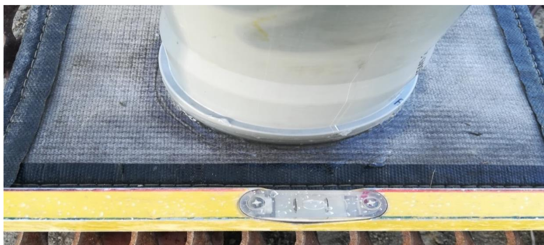
Рисунок 4.1 – Установленный образец бетонного полотна в горизонтальном положении с перпендикулярно стоящим столбом воды
