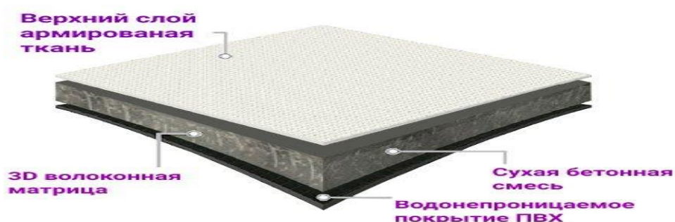
Рисунок 1.18 – Структура бетонного полотна
