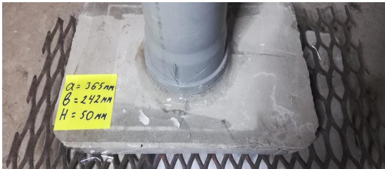
Рисунок 4.8 – Параметры бетонной плиты
