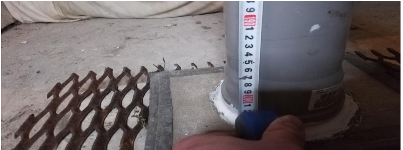
Рисунок 4.4 – Высота цилиндра установленного на образец бетонного полотна
