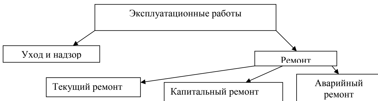
Рисунок 1.2 – Виды эксплуатационных работ на оросительных каналах
